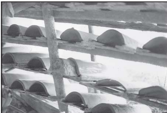
Estaleiro para secagem das telhas.
